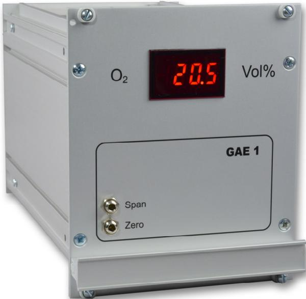
Der Gasanalysator ist mit einem chemischen Sensor ausgestattet. Sauerstoff absorbiert infrarotes Licht nicht in dem Maße wie andere Gase und wird aus diesem Grund mit Hilfe einer Sauerstoffmesszelle gemessen. Sauerstoffmesszellen stellen Generatoren dar, die keine äußere Spannungsquelle benötigen. Da die Messung mit einer chemischen Reaktion verbunden ist, verbraucht sich die Zelle bei Anwesenheit von Sauerstoff allmählich.
