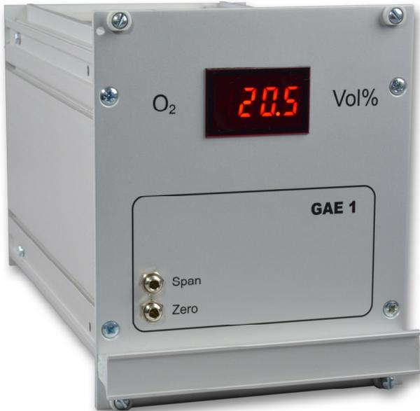
Der Gasanalysator ist mit einer paramagnetischen Messzelle ausgerüstet. Die O<sub>2</sub>-Messung des Analysators nutzt die paramagnetischen Eigenschaften des Sauerstoffmoleküls zur Konzentrationsbestimmung für genaue Messungen ohne Verschleiss.
