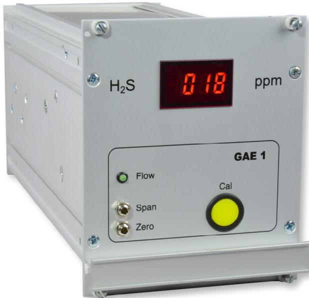
Der Gasanalysator ist mit einem chemischen Sensor ausgestattet. Die Messung des Schwefelwasserstoffes erfolgt kontinuierlich. Da der Gasanalysator eine hohe Druckempfindlichkeit aufweist, müssen die Gasausgänge drucklos in die Atmosphäre abgeleitet werden. Die Messung basiert auf einer chemischen Reaktion. Dadurch ist die Lebensdauer der Messzelle bei kontinuierlichem Messbetrieb auf ca. 2 Jahre begrenzt.
