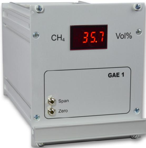
Der Gasanalysator arbeitet nach dem Prinzip eines nicht-dispersiv Infrarot-Fotometer (NDIR). Er erfasst die durch das Messgas verursachte Absorption von Infrarotstrahlung. Die Wellenlänge der Absorptionsbanden charakterisiert die Gasart, während die Stärke der Absorption ein Maß für die Konzentration der Messkomponente ist.
